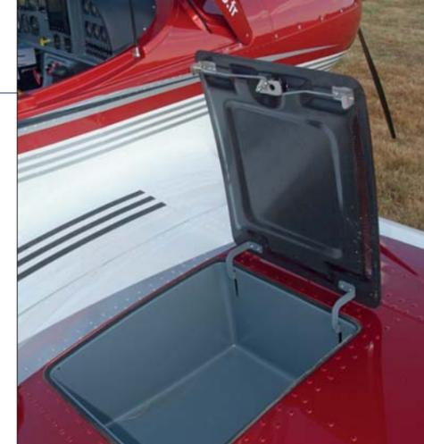
Le cockpit est très généreux. La planche de bord peut être équipée d'un glass cockpit à la demande. Les baggages peuvent être stockés dans les ailes.
